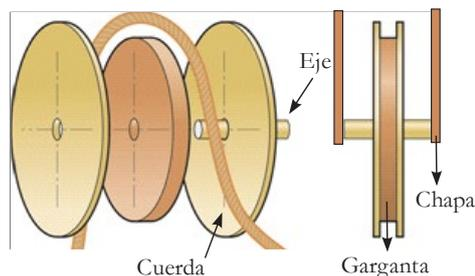
En la práctica la rueda debe ser maciza y se caracteriza por tener un canal esculpido en su borde, llamado garganta, por el que se va a acoplar el cable o la cuerda que transmite las fuerzas.
